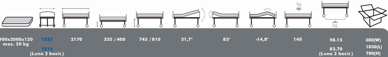
长度单位：mm，重量单位：kg，误差（长度±15 mm，重量1.5 kg，角度1.5°）。规格如有变更，恕不另行通知。
